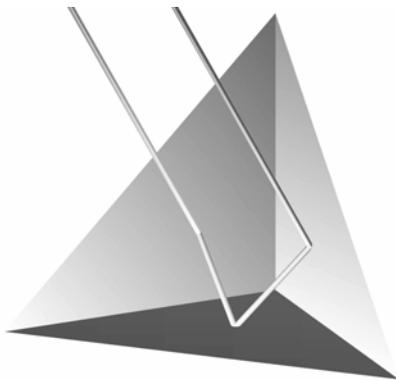
**Fig. 10: Triple reflector**
